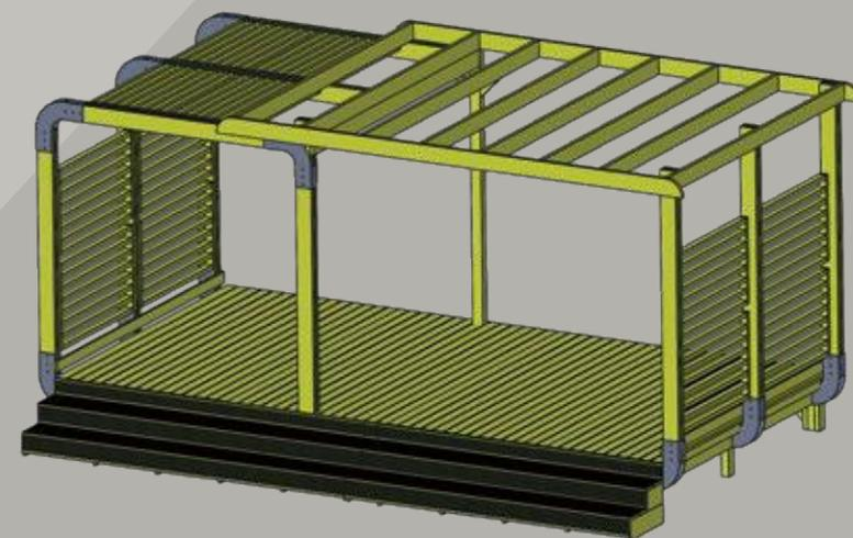
**Projet podium gamme design** 5,90x3,54 m avec 1 côté couvert toit à plat pour toile d'ombrage 4,00x3,30 m et 1 côté couvert persiennes bois
