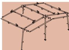
Armature spéciale ERIBA acier Prenox Ø25 mm avec système de blocage T-REX.
