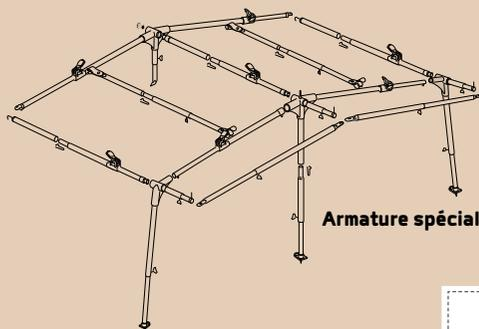
Armature spéciale Eriba de qualité acier Prenox Ø25 mm anti-corrosion avec système de blocage T-REX.
